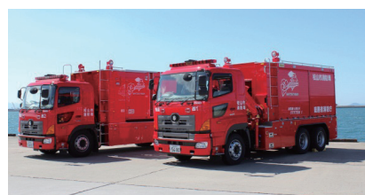
配備された海水利用型消防水利システム 右が「大型動力ポンプ付消防自動車」 左が「コンテナ式ホース延長車」
